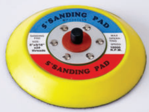
รหัสสินค้า : FCHNPADUF502A ขนาด : 5" ขนาดเกลียว : 5/16"-24 ความหนา : 16 มิลลิเมตร หลัง : สลักะหลาด
